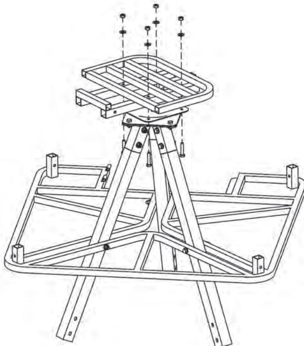
**Step 5:** Attach **SEAT FRAME** on top **SWIVEL**
